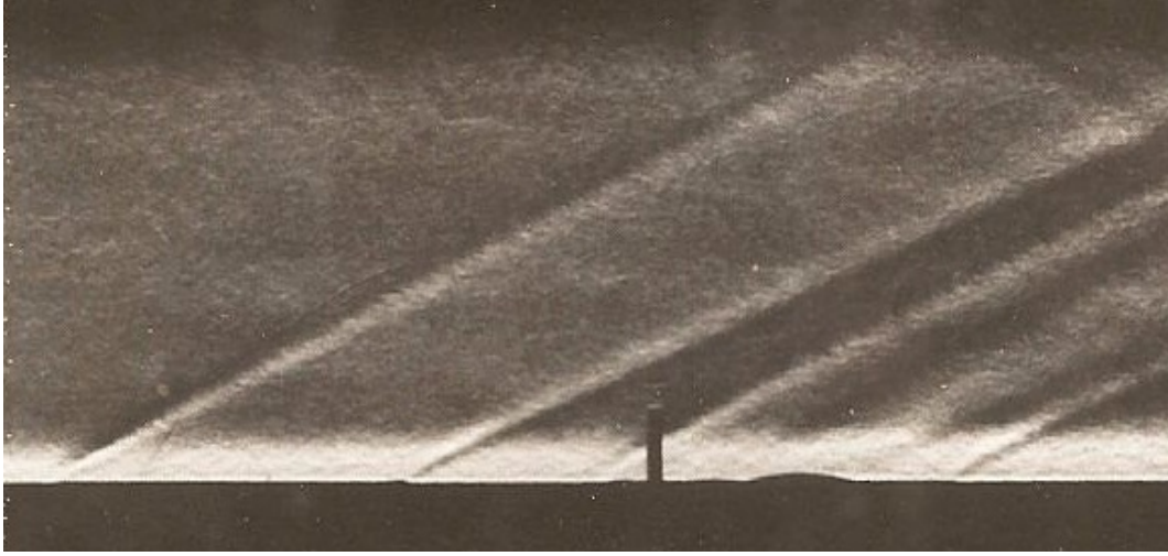
FIGURE 4.4 – Ondes de Mach dans une tuyère supersonique, générées par des bandes de scotch collées sur la paroi (Noca 1989, California Institute of Technology)
